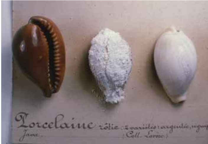
Eflorescencia de sales (polvo blanco) en una concha de una colección de historia natural, causada por la reacción química con el ácido acético, un contaminante gaseoso (Foto: Archivos del ICCROM).
